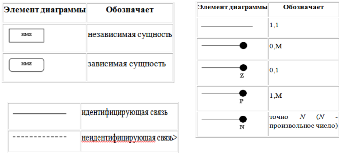
Рис. 5. Виды сущностей и связей в нотации IDEFx1
