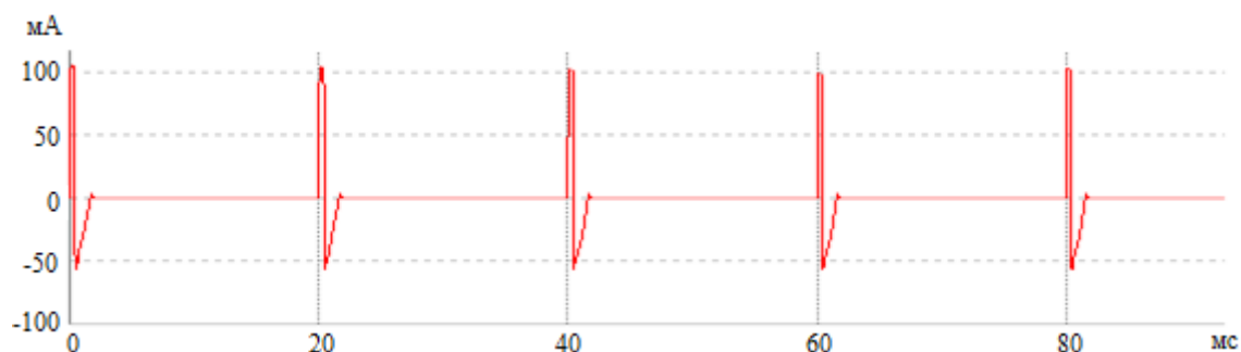
Рис. 5. Импульсы тока на выходе БФС
